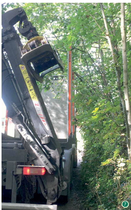
Bild 7: Mangelhaftes Lichtraumprofil! Bild 8: Lkw unter einer Leitung! Bild 9: Unnötig weit ausgelegtes Holz!
